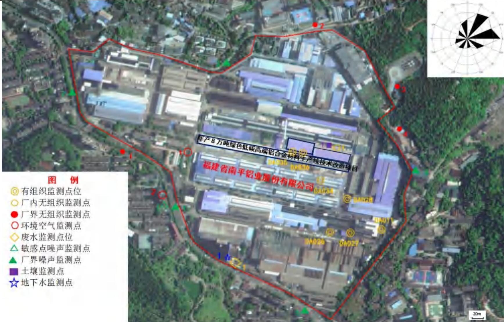
图 7.1-1 废气、环境空气、废水、噪声、地下水、土壤监测布点图
